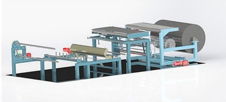
Slittercutter : Role sarılı olan malzemelerin rolden çözülerek kullanım ihtiyacına göre kesim ve sınıflandırma yapma makinesi
